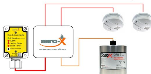
Schema eines Standardaufbaus des Aero-X SAFES® Schranklöschesystems
